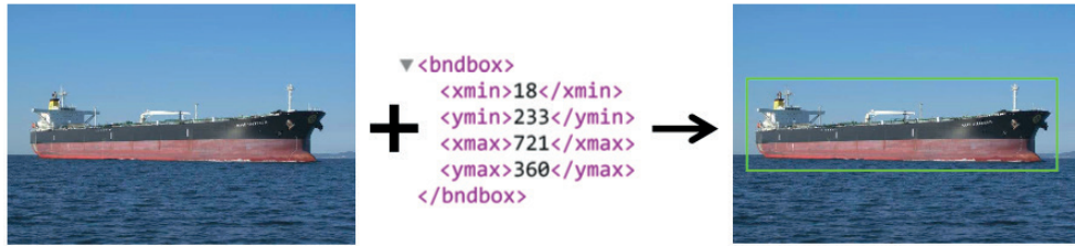
Şekil-25: Sınırlama Kutusu İşlem Süreci ve Hedefin Çerçeveselmesine Ait Görsel 65
